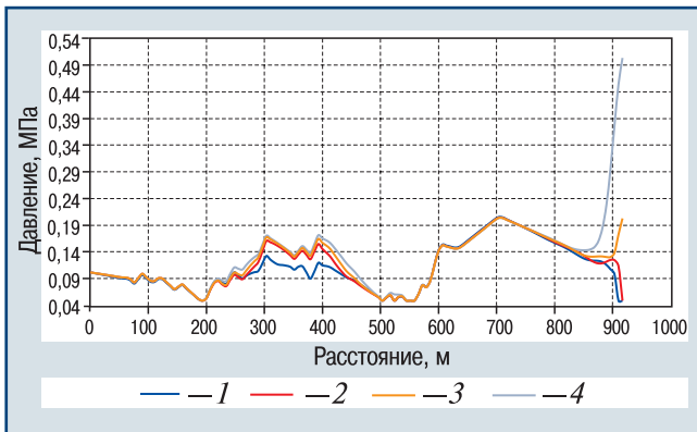
▲ Рис. 9. Профиль давления через 3,7394 с (линия 1); 3,7728 с (линия 2); 3,787 с (линия 3) и 3,8021 с (линия 4) после начала закрытия задвижки
