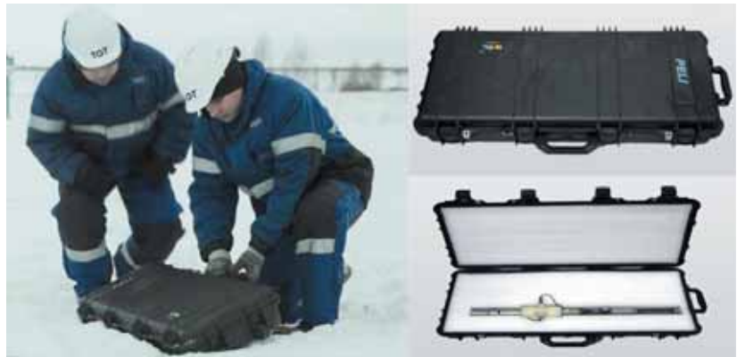
▲ Рис. 2. Оборудование для мобильной калибровки данных прибора пассивной акустики
