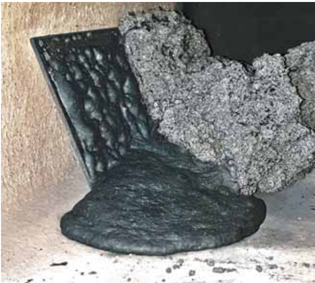
▲ Рис. 7. Влияние излишнего разбавления краски на свойства пенококса ▲ Fig. 7. Influence of excessive paint dilution on the coke foam properties
