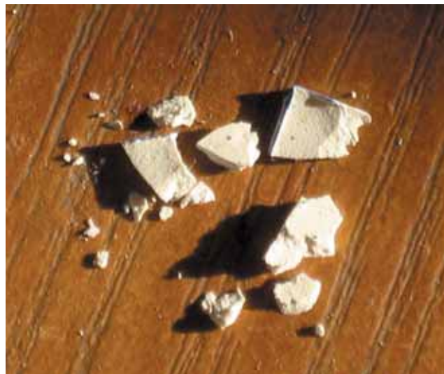
▲ Рис. 1. Разрушенные при вырезании образцы краски Defender M Solvent
